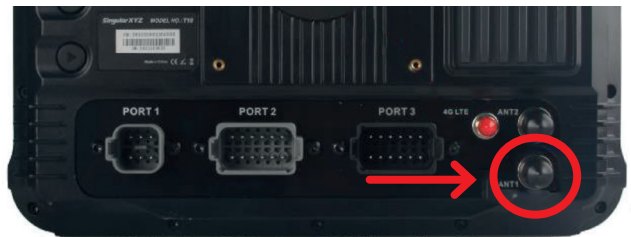
2 pav. Antenos lizdas monitoriaus nugarinėje pusėje
